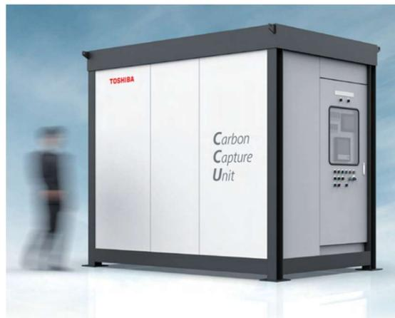
CO<sub>2</sub>分離回収設備は、火力発電所や清掃工場などから排出されるCO<sub>2</sub>を回収するための設備です。東芝エネルギーシステムズではCO<sub>2</sub>の回収方法として、燃焼排ガスに広く適用でき、CO<sub>2</sub>の回収規模が任意に設定可能な化学吸収方式による燃焼後回収技術を採用しています。本方式で用いる水溶液は、低温時にはCO<sub>2</sub>を吸収し、高温時にはCO<sub>2</sub>を放出するという特性を有しており、その特性を利用してCO<sub>2</sub>を分離回収します。
